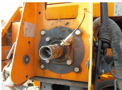
图3 转速传感器安装情况
