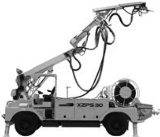
喷射混凝土施工技术在隧道建设领域应用很广，目前我过喷射混凝土施工普遍采用的是干喷和潮喷，随着施工技术的不断发展，一种新的喷射混凝土施工技术——湿式喷射混凝土正逐渐运用于喷射混凝土施工作业中 [1]。
