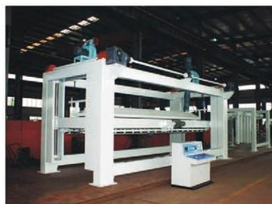
加气混凝土砌块生产线成套设备
