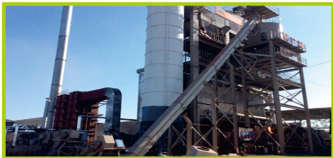
介质加热式新型厂拌热再生设备
